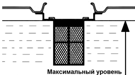
Рис. 7 Максимальный уровень топлива
