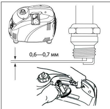
Зазор между электродами должен составлять 0,6-0,7 мм.
