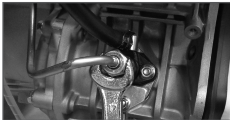
Рис. 12 Удаление воздуха из топливного насоса
