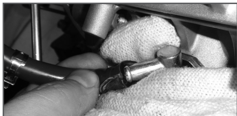
Рис. 10 Удаление воздуха из топливного шланга
