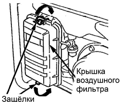
Рис. 14 Снятие крышки воздушного фильтра
