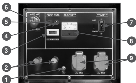
Рис. 3 Панель управления DG10000E
