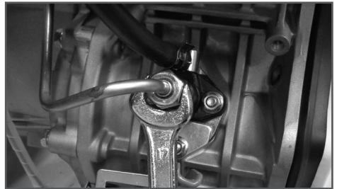
Рис. 12 Удаление воздуха из топливного насоса
