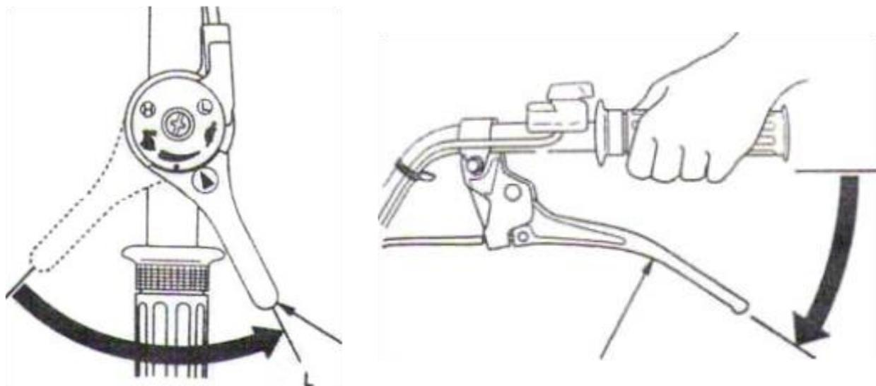
3. Поверните флагжок топливного крана в положение **OFF**.
