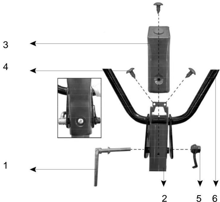
Открутите затяжной винт **1** и гайку **5** и вставьте рукоятки управления **6** в скобу на стойке **2**. Закрутите винт **1** и гайку **5**. Установите накладку **3** Сверху стойки и зафиксируйте её шурупами **4**.
