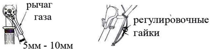
Допустимый люфт рычага газа 5-10 мм.
