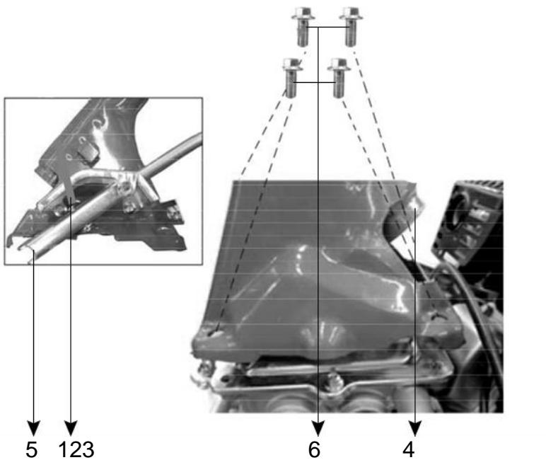
Вставьте рычаг **5** в отверстие в планке с указанием передач. Закрепите рычаг **5** к стойке **4** с помощью пальца **1**, шайбы **2** и шплинта **3**. Установите стойку **4** на раму устройства и закрепите её с помощью болтов **6**.
