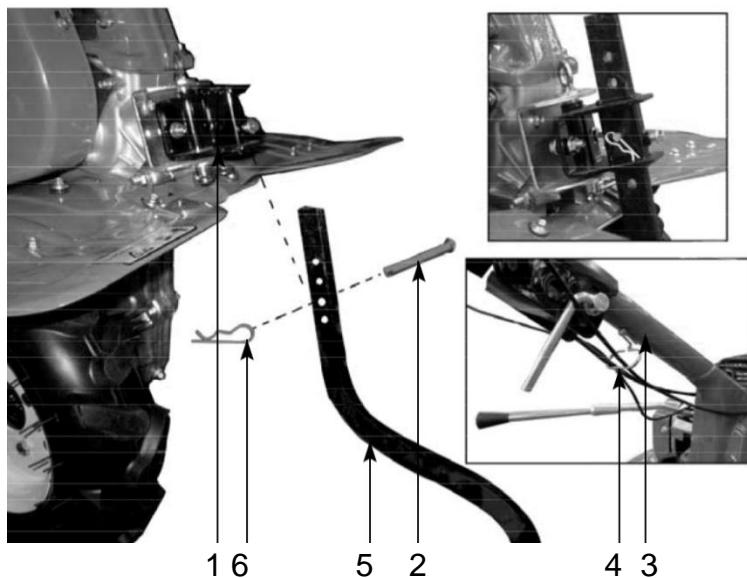
Установите переходник **1** на раму культиватора и закрепите его. Вставьте в переходник **1** ограничитель **5** и зафиксируйте нужную высоту пальцем **2** и шплинтом **6**. Установите рамку **4** и закрепите её к опоре шурупом **3**.
