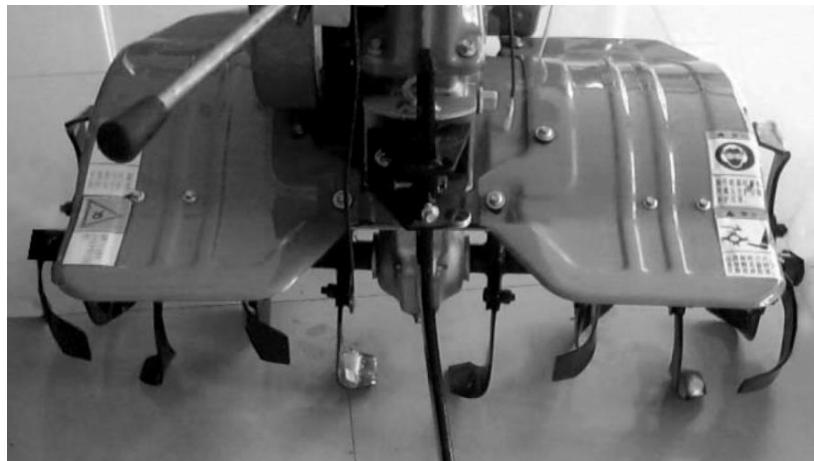
Установите фрезы **2** на вал редуктора Обратите внимание, что одна из фрез Имеет маркировку R, что значит правая, вторая – L, что значит левая). Затем зафиксируйте фрезы пальцами **1**, а пальцы заблокируйте шплинтами **3**.
