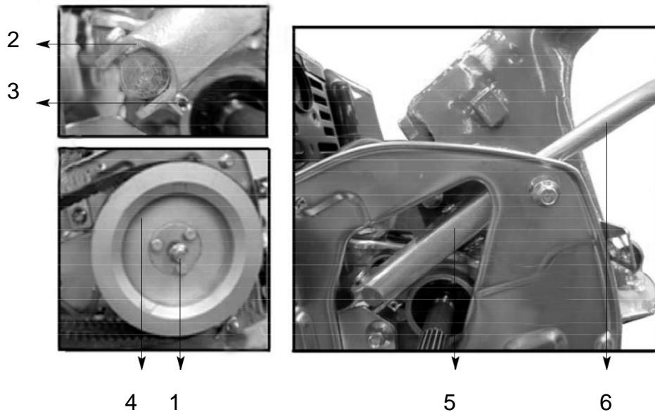
Снимите кожух ременной передачи и открутите болт **1** так, чтобы снять шкив редуктора **4**. Установите вилку **5** рычага переключения передач **6** на ось редуктора и закрепите её с помощью пальца **2** и шплинта **3**. Установите шкив **4** на место и закрепите его болтом **1**.
