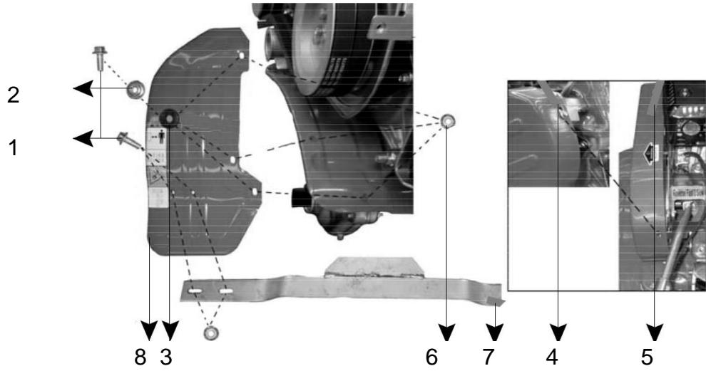
Вставьте втулку **3** в отверстия в кожухе **8** и **9**. Закрепите кожуха **8** и **9** на раму устройства с помощью болтов **1** и гаек **6**. Установите кожух **5** и закрепите его болтами **4**.
